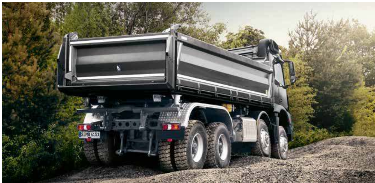
Fleksibel ramme. Til entreprenørkørsel er Arocs udstyret med den smalle og særdeles fleksible ramme. Således overføres den høje kraft til underlaget uden tab også i ujævnt terræn.
