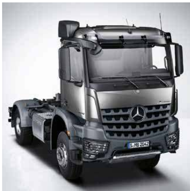
S-førerhuset ClassicSpace 3) . Den 2300 mm brede og 1700 mm lange kabine med en 170 eller 320 mm høj motortunnel er konstrueret, så den passer præcist til alle de udfordringer, en alenearbejdende chauffør står over for i forbindelse med entreprenørkørsel, og giver mulighed for et godt udsyn.
