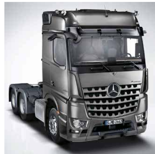
L-førerhuset BigSpace. Kabinen med plant gulv og en bredde på 2500 mm giver en ståhøjde på 1,99 m mellem sæderne og dermed ualmindelig stor bevægelsesfrihed og en bekvem mulighed for gennemgang til passagersiden.
