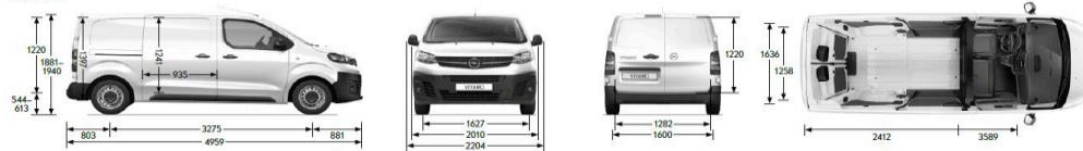
Vivaro Cargo M Alle Maße in mm
