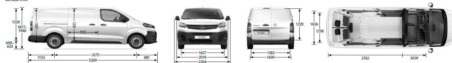
Vivaro Cargo L Alle Maße in mm
